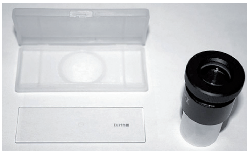
Micrometro oggetto e oculare micrometrico
