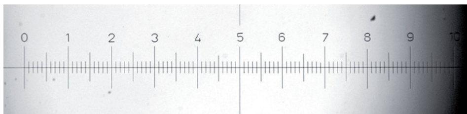
Immagine ingrandita della scala graduata del micrometro oggetto
